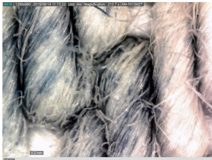
Slika 34. Uzorak obrađen otopini KMnO_4 : a) povećanje 55x; b) povećanje 230x
