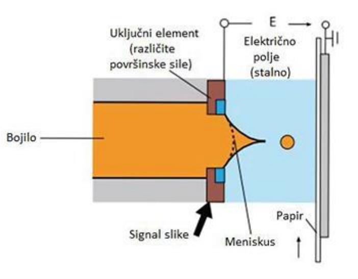
Slika 9. Princip rada elektrostatskog ink jet tiska [14]
