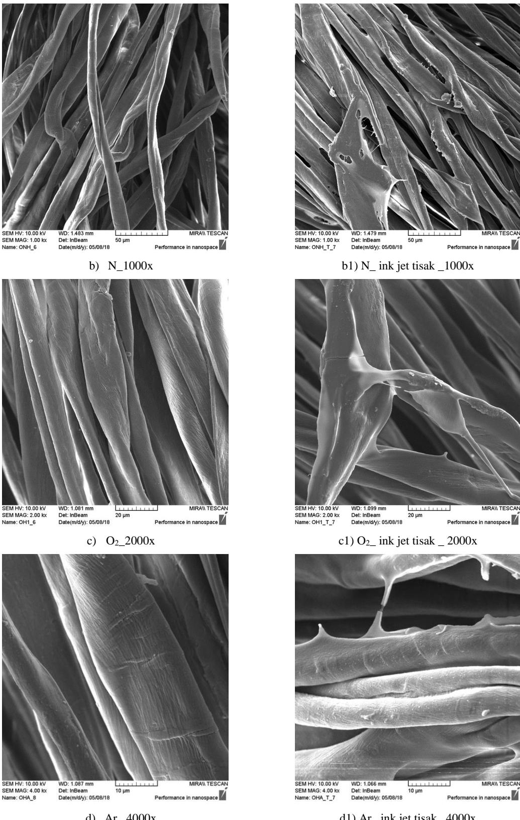
**Slika 18.** SEM snimke pamučnih vlakana prije i nakon obrada plazmom i ink jet tiskom: a,b) neobrađeni uzorak, povećanje 120 i 1000x; a1,b1) neobrađeni uzorak + ink jet digitalni tisak, povećanje 120 i 1000x; c) kisikova plazma, povećanje 2000x i c1) kisikova plazma + ink jet tisak, povećanje 2000x; d) argonova plazma, povećanje 4000x, d1) argonova plazma + ink jet tisak, povećanje 4000x.
