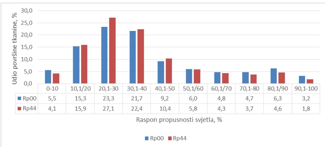
**Slika 20.** Propusnost svjetlosti uzorka tkanina u rips vezu Rp00,Rp44
