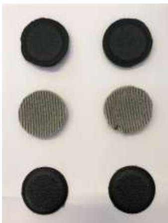
Slika 18. Prikaz uzoraka nakon habanja (40 000 ciklusa)
