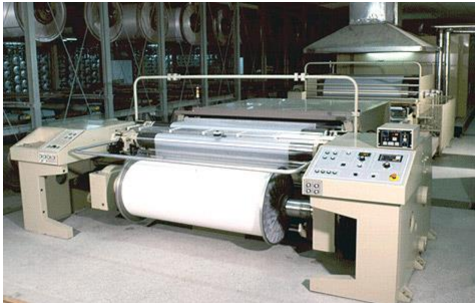
SI. 8. Stroj za škrobljenje TTS10F [21]
