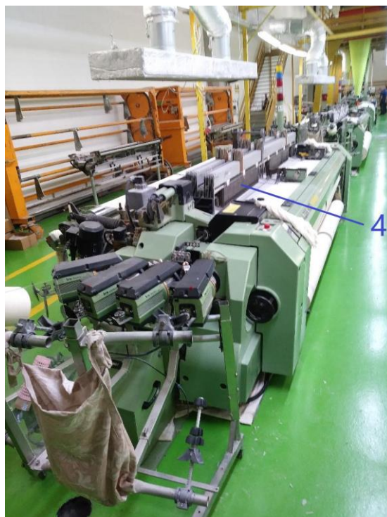
SI. 14. Tkalački stroj s unosom potke projektilom
