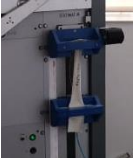
Sl. 23. Istezanje jednog od uzoraka na dinamometru Statimat M – tt. Textechno, Njemačka
