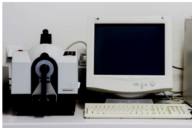
Slika 12. Remisijski spektrofotometar DataColor SP600+ CV UV []
