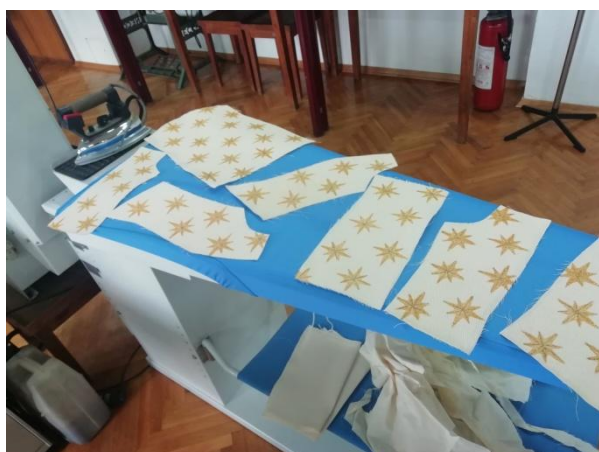
Slika 10. Fiksiranje boje na krojnim dijelovima glačalom
