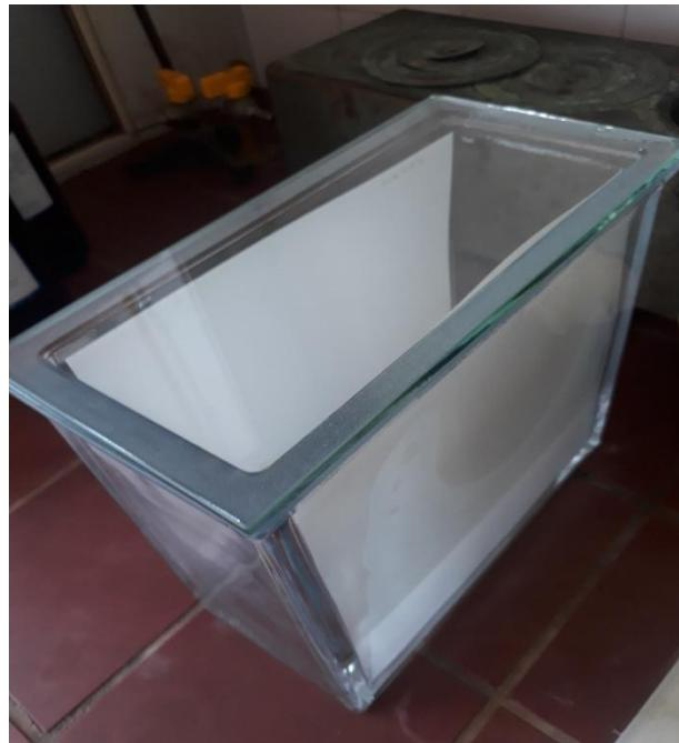
Slika 40: Razvijanje kromatograma
