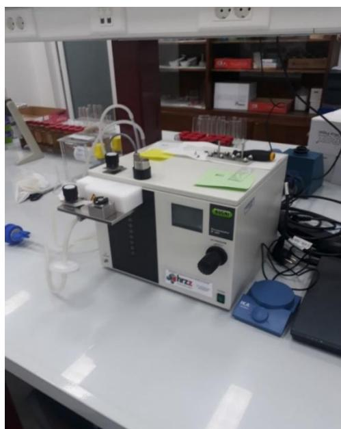
Slika 30: Uređaj za mikrokapsuliranje
