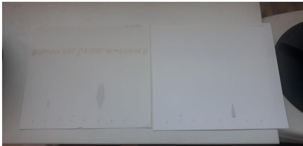
Slika 42: Razvijeni kromatogram s uzorcima 1-8 nakon vizualizacije parama NH<sub>3</sub>
