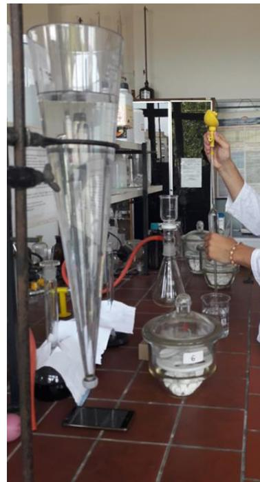
Slika 11. Određivanje taložive tvari i priprema za određivanje suspendirane tvari
