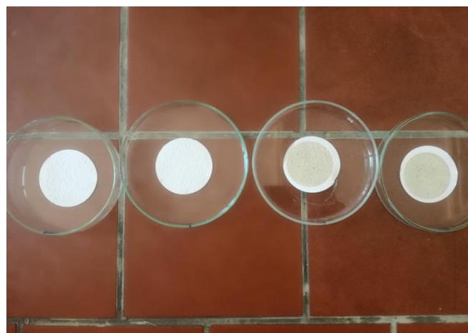
Slika 12. Rezultati određivanja suspendiranih tvari vodi za ljudsku potrošnju (lijevo) i u površinskoj vodi (desno)
