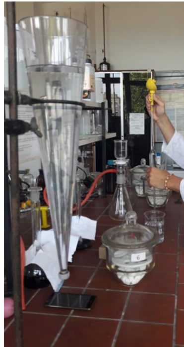
Slika 11. Određivanje taložive tvari i priprema za određivanje suspendirane tvari
