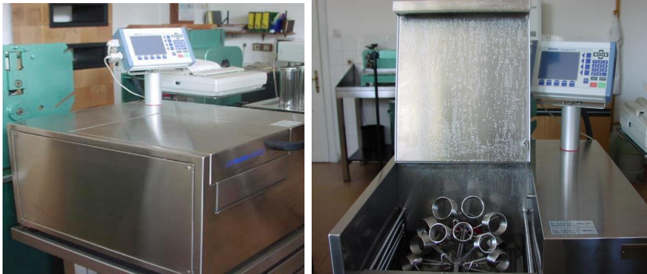
Slika 24: Uređaj za obradu uzoraka Turbomat, P 4502, Mathis, Švicarska: a. izgled; b. unutarnji dio
