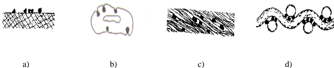
Slika 1: Način vezivanja prljavština na tekstilno vlakno: a) na površini; b) u šupljinama vlakna; c) u međuprostorima; d) između niti [1]
