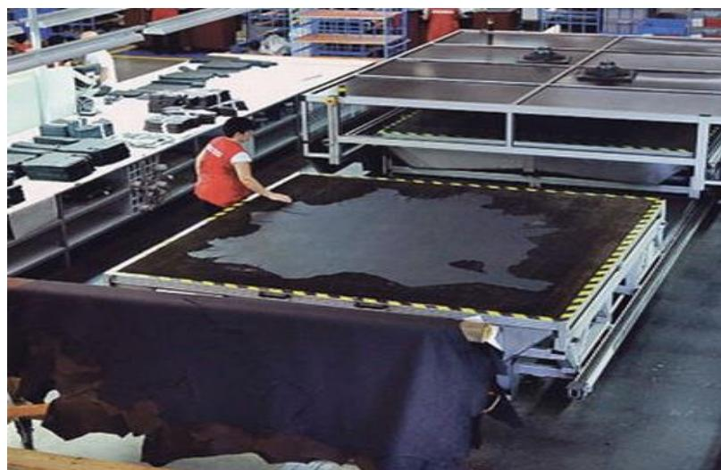
Slika 8. Agregat s nadzvučnim mlazom vode [13]
