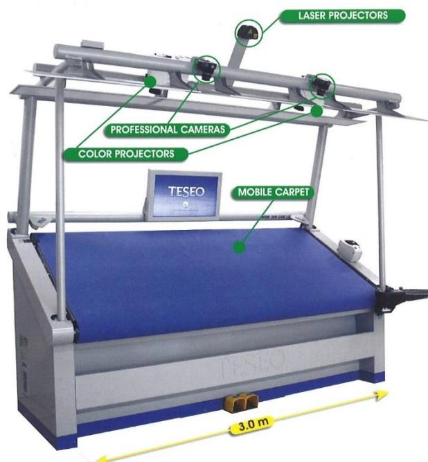
Slika 4. Stroj za skeniranje i označavanje kože [11]
