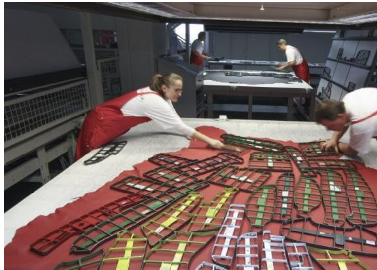
Slika 9. Ručno polaganje štanci za iskrojavanje [14]
