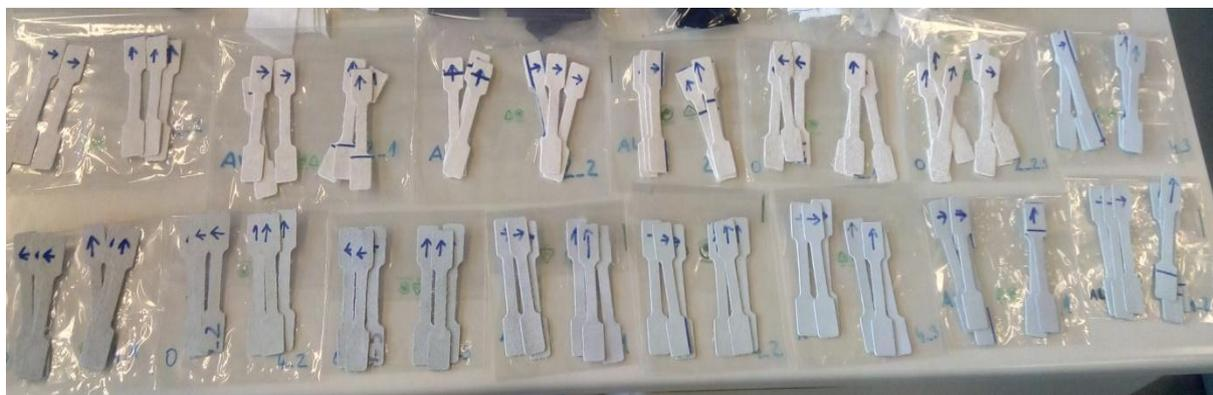
Slika 17. Ispitne epruvete za određivanje prekidne čvrstoće
