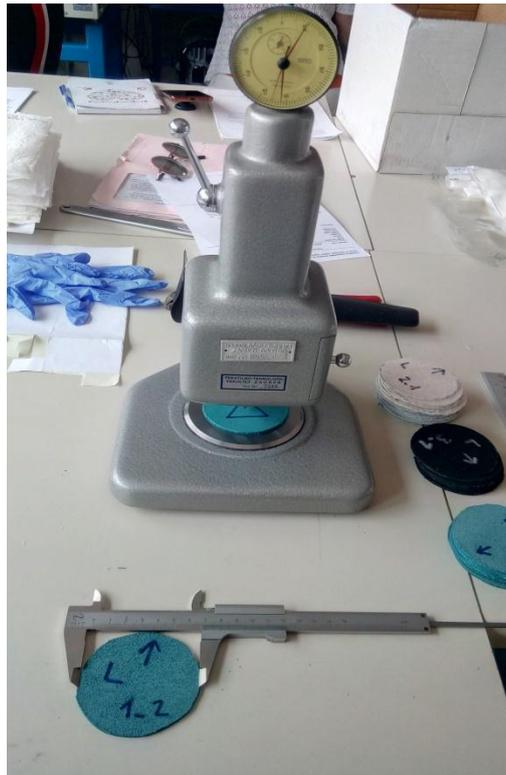
Slika 14. Mjerenje debljine i promjera
