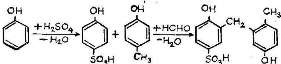
Slika 5. Kemijska struktura sintana – treći osnovni tip[4]
