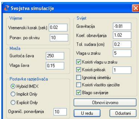
Sl. 30 Prikaz izbornika posebnih svojstava simulacije i efekta „napuhivanja“
