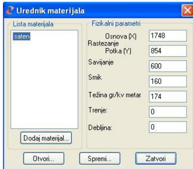
Slika 29 Izbornik za definiranje parametara svojstava materijala
