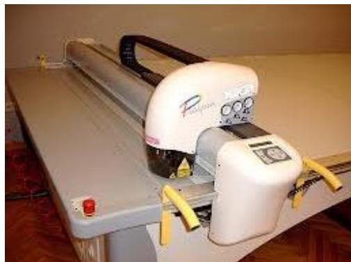
Sl. 20 Agregat za iskrojavanje
