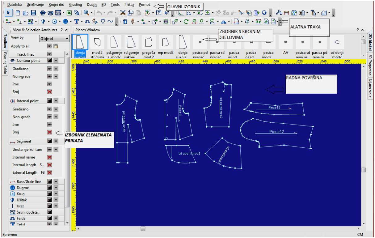
S1. 22 Prozor programa Pattern Design System – PDS s prikazom digitaliziranih krojnih dijelova
