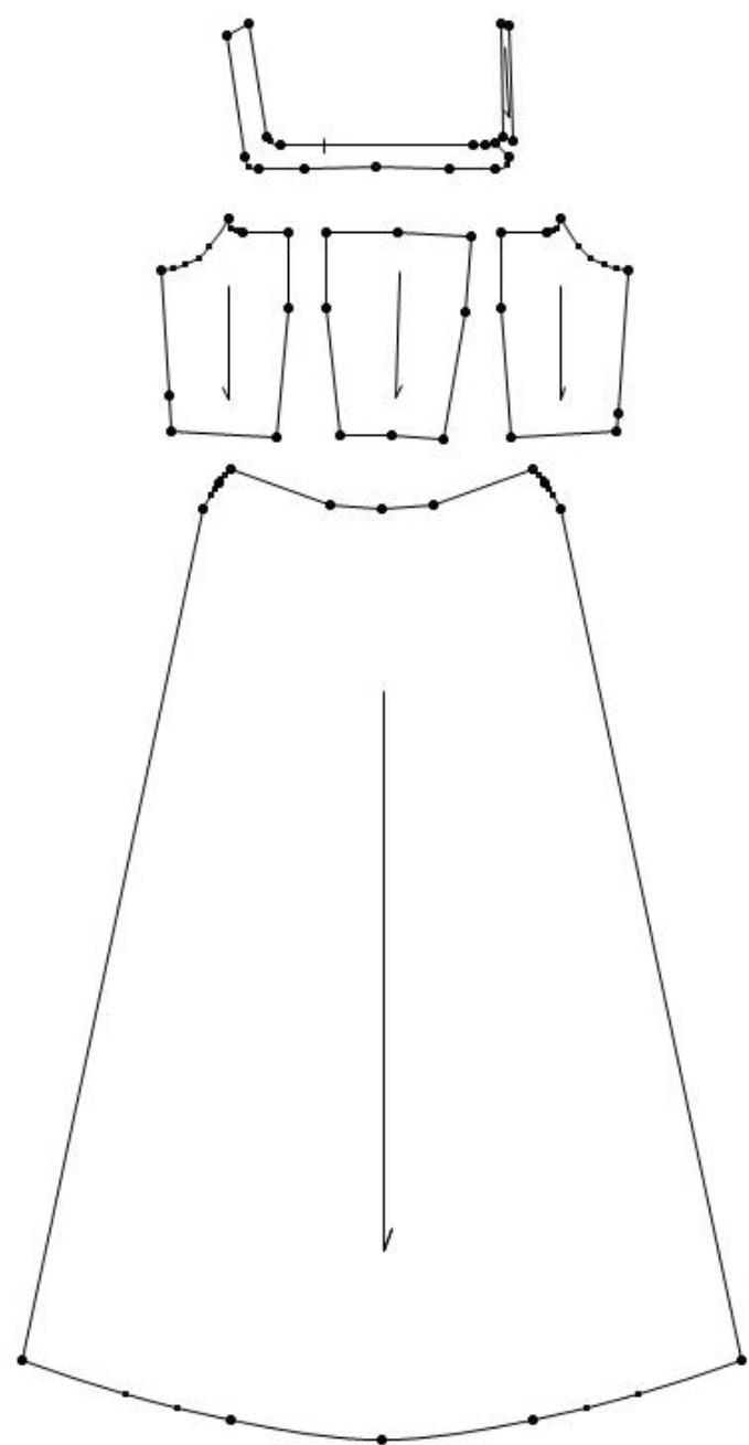
Sl. 95 Modelirani krojni dijelovi stražnjeg dijela modela vjenčanice
