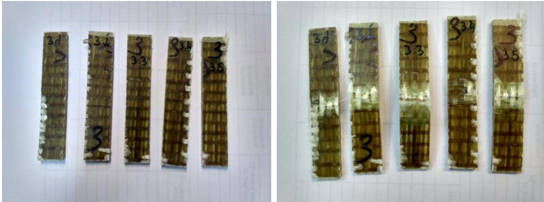
Slika 45. Epruvete kompozitne ploče S1L1_I. za ispitivanje savojne čvrstoće prije i poslije ispitivanja
