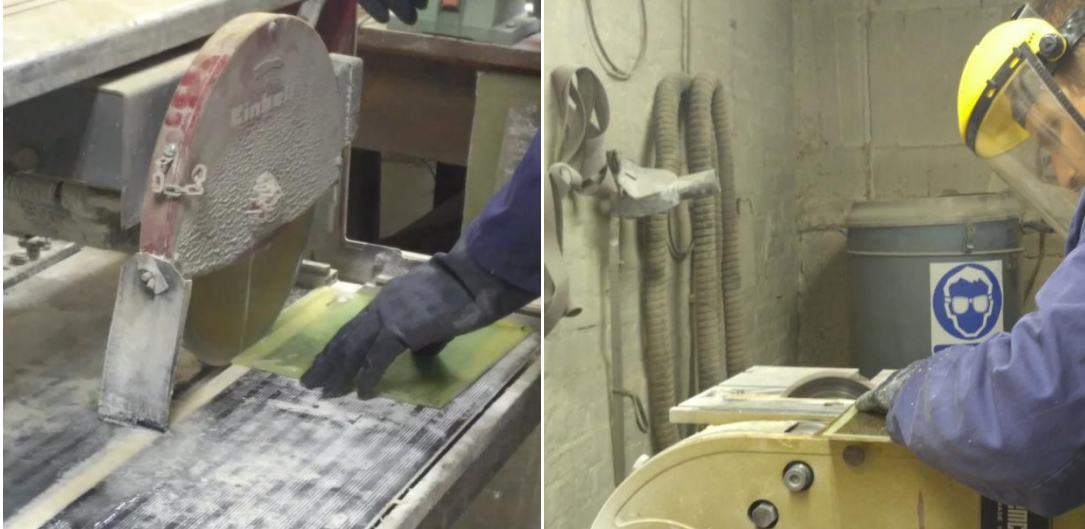
Slika 27. Rezanje ploča na mokrom i suhom rezaču
