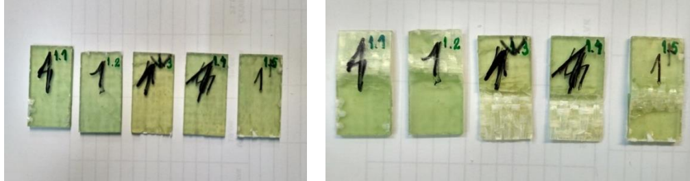
Slika 49. Epruvete kompozitne ploče S1_IV. prije i poslije ispitivanja međuslojne tvrdoće
