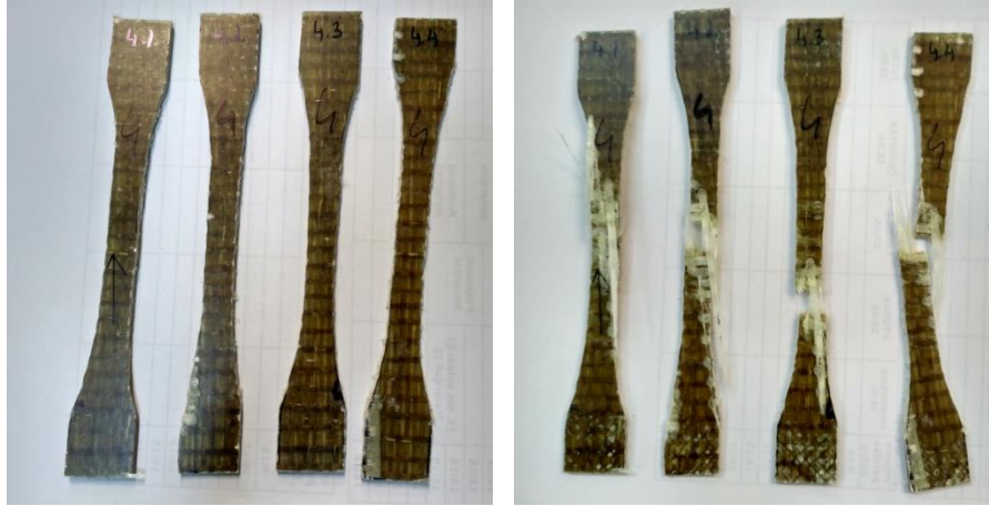
Slika 39. Epruvete kompozitne ploče SIL1_II. za ispitivanje vlačne čvrstoće prije i poslije ispitivanja
