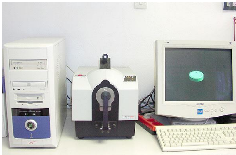
Slika 9: Remisijski spektrofotometar Spectraflaf SF 600 PLUS-CT
