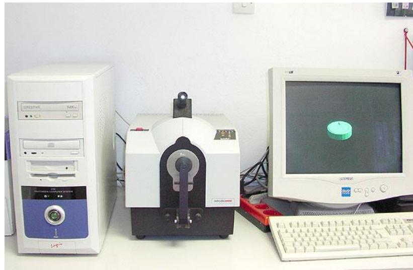
**Slika 9:** Remisijski spektrofotometar Spectraflasf SF 600 PLUS-CT
