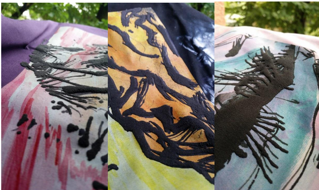
Slika 47: Gotovi uzorci otisnuti pigmentnom pastom s bubrećim efektom
