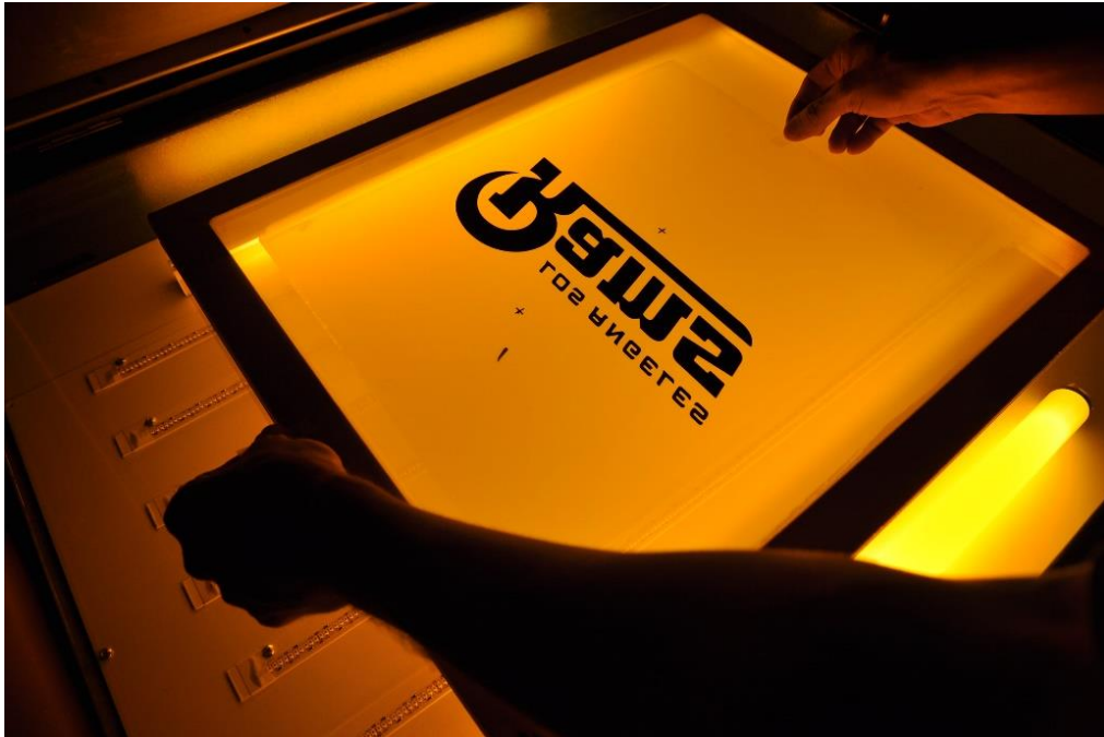
Slika 8: Prikaz osvjetljavanja šablone u zamračenoj sobi [15]
