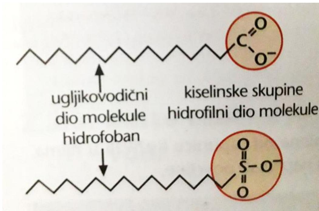
Slika 8: Shematski prikaz molekula s hidrofilnim i hidrofobnim dijelom [1]
