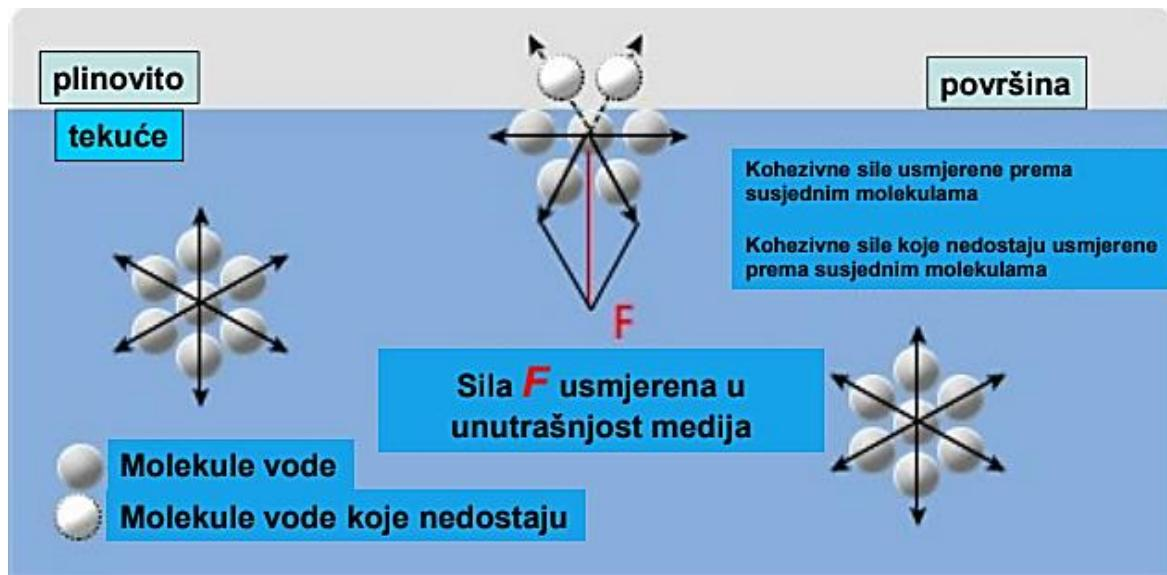
Slika 6: Prikaz kohezivnih sila usmjerene prema susjednim molekulama [11]
