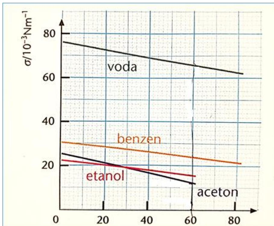
Slika 4: Ovisnost napetosti površine o temperaturi [1]
