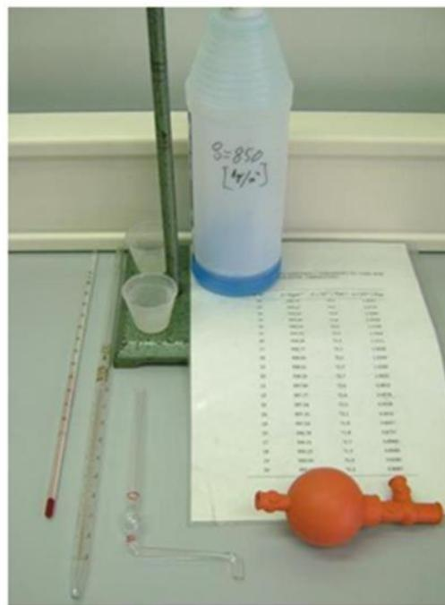
Slika 10: Pribor za mjerjenje površinske napetosti stalagmometrom (termometar, pipeta, stalagmometar, dvije čaše, stalak sa držačem, propipeta, tablica sa vrijednostima površinske napetosti pri različitim temperaturama). [16]
