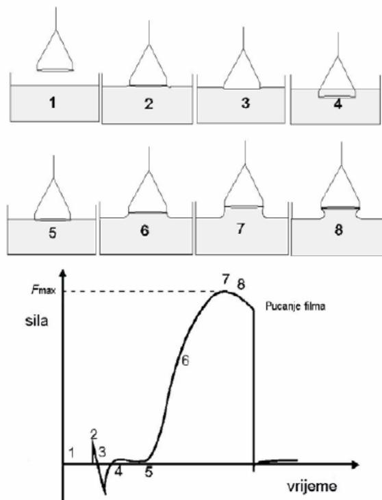
Slika 13: Promjena površinske napetosti uzorka tijekom mjerena Du Nouy-evom metodom prstena [8]
