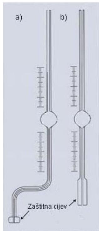
Slika 12: Stalagmometar za ispitivanje viskoznih tekućina [8]
