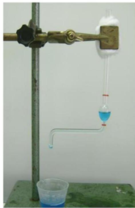
Slika 11: Detalj sastavljene aparature za mjerjenje napetosti površine stalagmometrom.[16]
