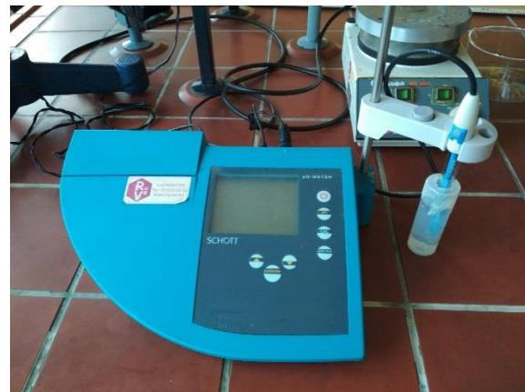
Sl. 12 pH – metar sa pripadajućom elektrodom
