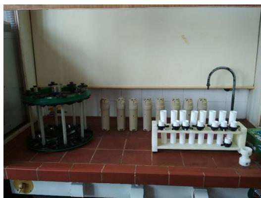
Sl. 18 Otvorene kivete i pravilno odloženi čepovi kiveta na odgovarajućem stalu, iza-keramička kućišta za kivete, lijevo- prazan rotor bez poklopca
