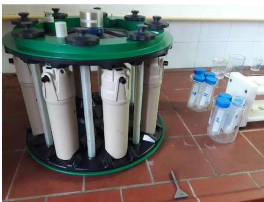
Sl. 19 Zatvorene kivete u keramičkim kućistima učvršćene u rotor, specijalni ključ za otvaranje ventila za odzračivanje (isključivo za otvaranje-nakon digestije)
