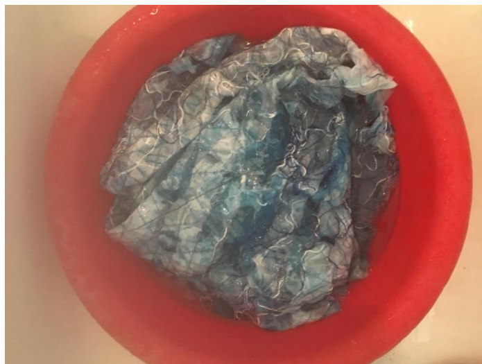
Slika 17. Otapanje vodotopive folije
