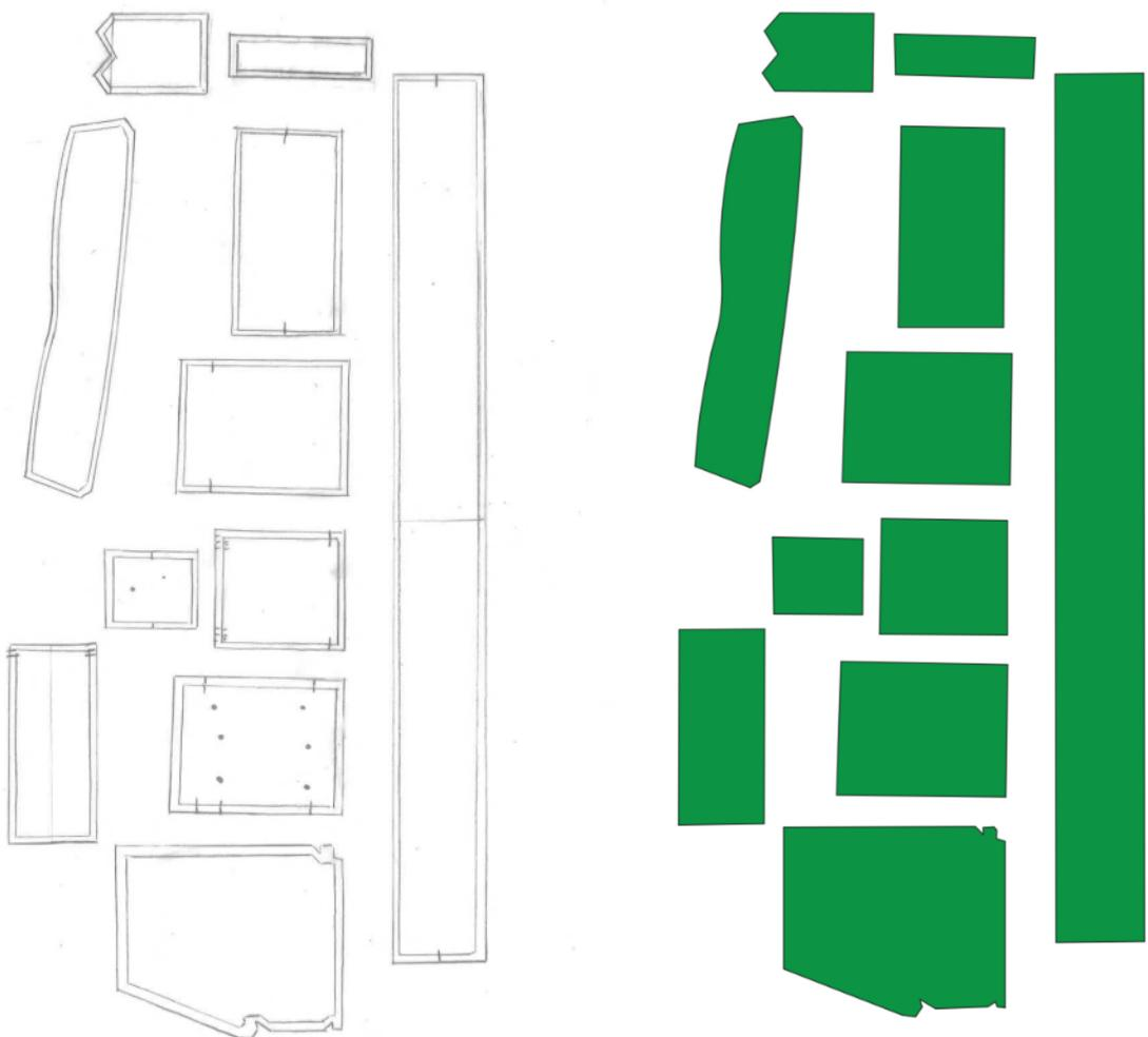
Slika 34. Prikaz modeliranih krojnih dijelova ženske jakne sa šavnim dodacima (džepovi, džepovina, preklopi za džepove, nabori za džepove, pojasnica, ovratnik, držač za pojasnici)
