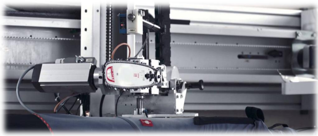
Slika 24. Prikaz uređaja za ispitivanje otpornosti pri rezanju lančanom pilom [17]
