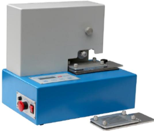
Slika 28. Prikaz uređaja za ispitivanje presijecanja zaštitnih rukavica [12]
