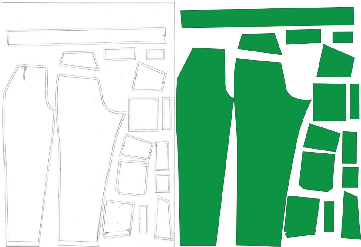
Slika 35. Prikaz modeliranih krojnih dijelova ženskih zaštitnih hlača sa šavnim dodacima (hlače, džepovi, poklopci za džepove, džepovina, letvica za prekrivanje zatvarača, pojasnica, držači remena)
