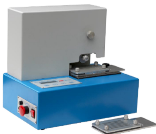
Slika 28. Prikaz uređaja za ispitivanje presijecanja zaštitnih rukavica [12]
