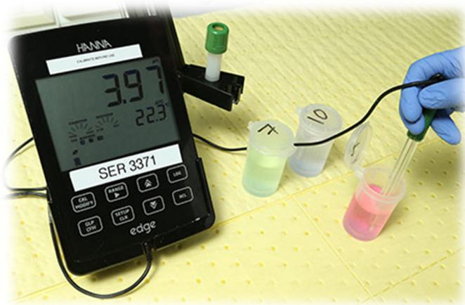
Slika 26. Prikaz ispitne metode određivanja pH vrijednosti materijala od kojih su izrađene zaštitne rukavice [19]
