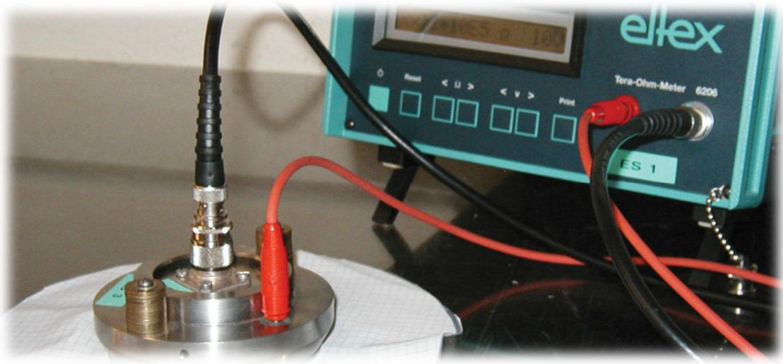
Slika 25. Prikaz uređaja za ispitivanje elektrostatičnih svojstava [18]
