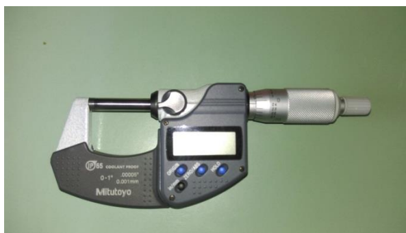
SI. 3.3.2.1. Debljinomjer – mikrometar.
