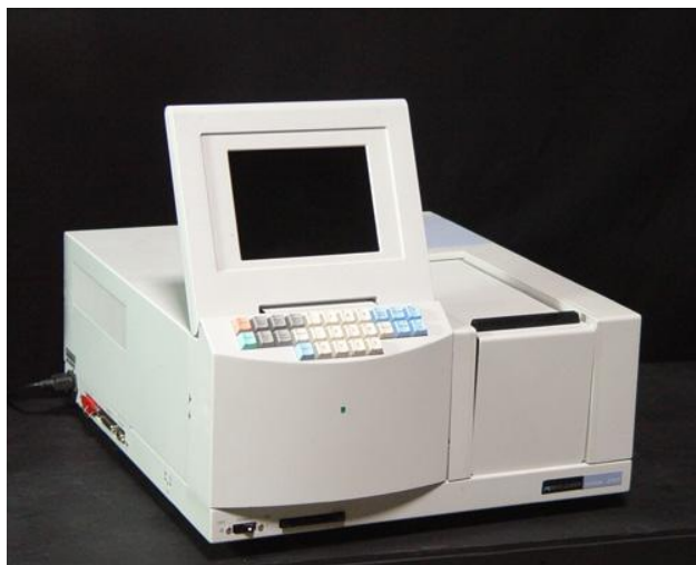
SI.3.3.5.1. UV/Vis spektrofotometar, Perkin Elmer Lambda EZ 201 [40].
