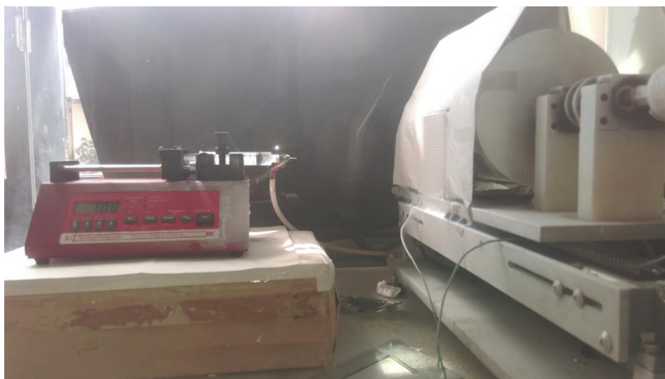
Sl. 3.2.2.1. Uređaj za elektroispredanje – Sveučilišta u Zagrebu, Tekstilno-tehnološki fakultet.
