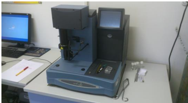
SI. 3.3.3.1. TGA analizator Q500, TA Instruments.
