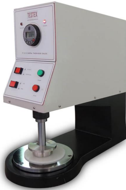
Slika 2. Debljinomjer preciznosti 0,01mm
