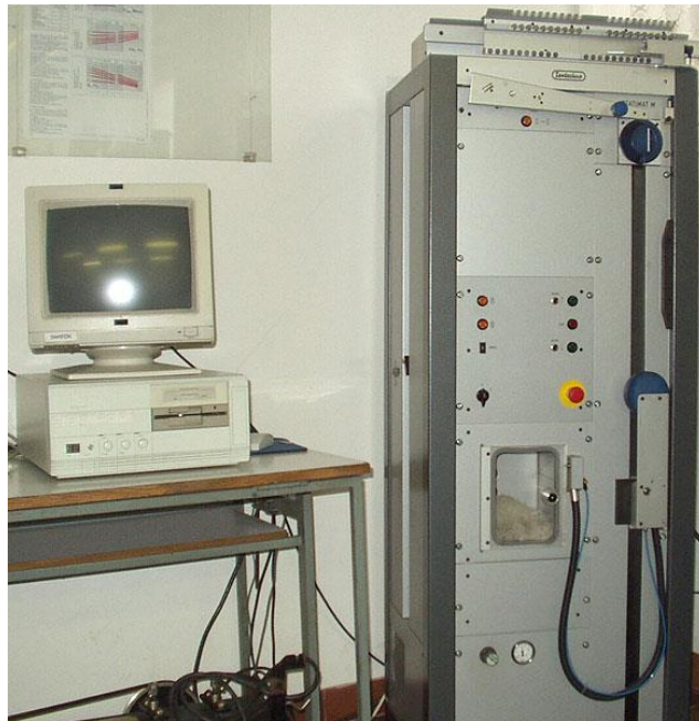
SI. 12. Dinamometar Statimat M za mjerenje vlačnih svojstava pređe
