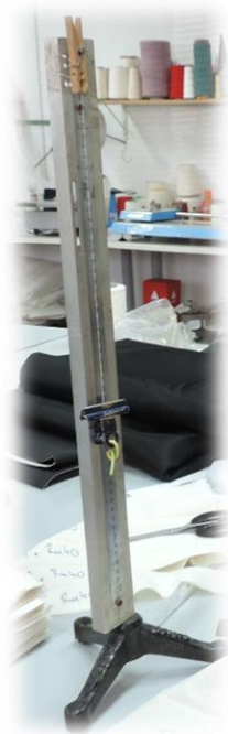
Sl. 15. Postupak određivanja utroška niti u tkanini (utkanja)
