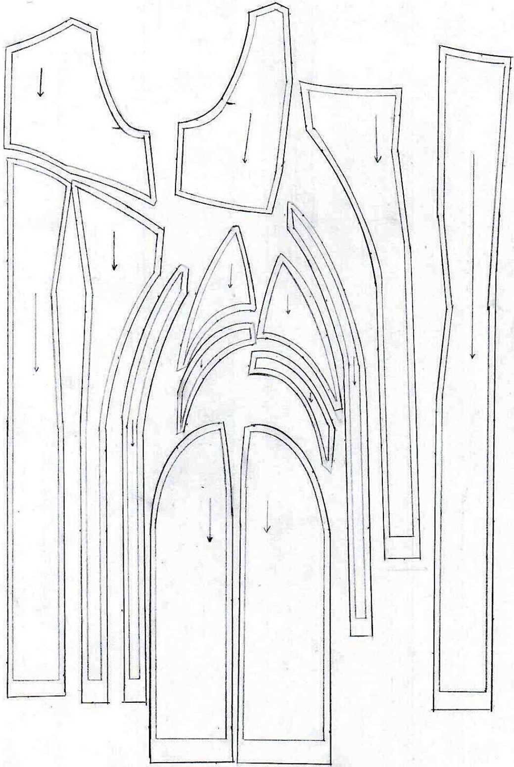
Slika 51: Prikaz krojnih dijelova i šavnih dodataka modela haljine za ženski tip tijela “pješčani sat“
