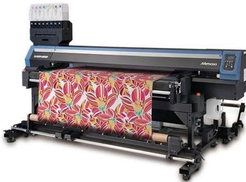
Slika 36. – Prikaz Direct Inkjet stroja
