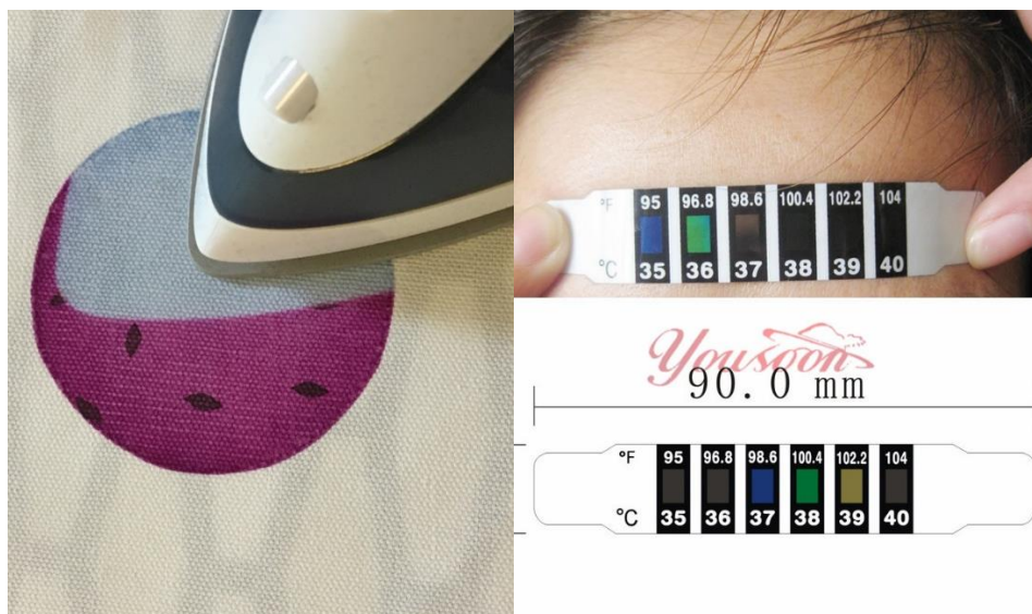
Sl.19. Primjer termosenzitivnog otisaka i fleksibilne folije za očitavanje temperature
