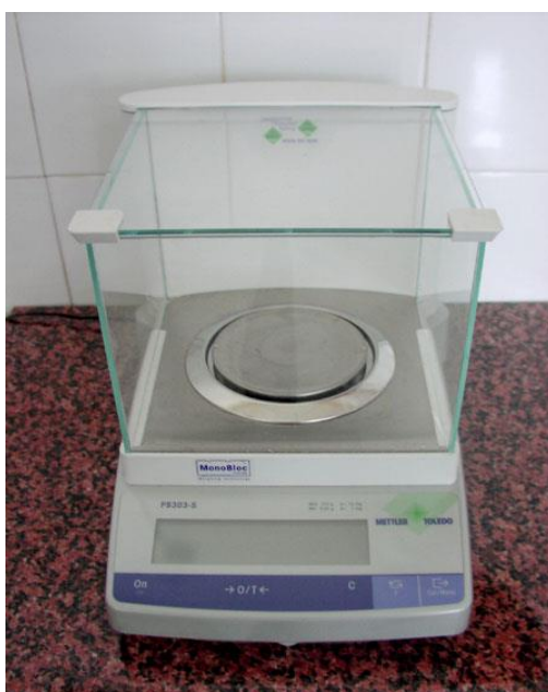
Slika 7. Digitalna vaga s točnošću mjerenja 0,001 g
