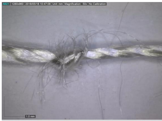
Slika 62. Fotografija konfiguracije U11 nakon procesa habanja
