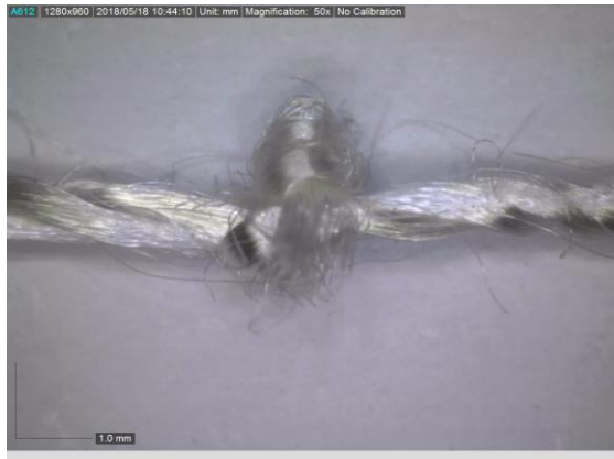
Slika 54. Fotografija konfiguracije U3 nakon procesa habanja
