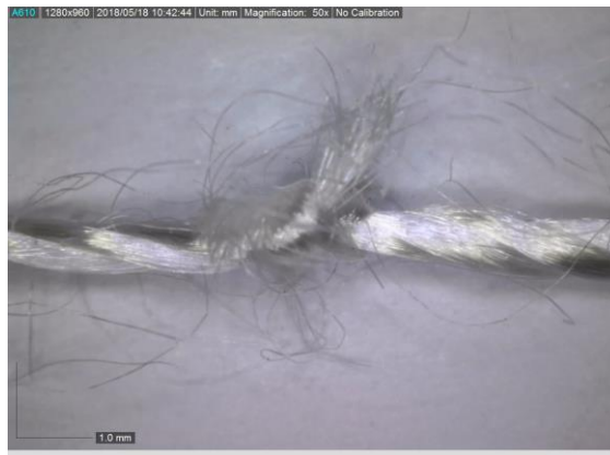
Slika 52. Fotografija konfiguracije U1 nakon procesa habanja
