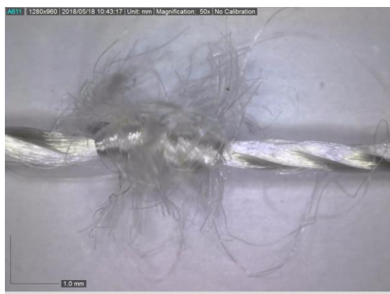
Slika 53. Fotografija konfiguracije U2 nakon procesa habanja
