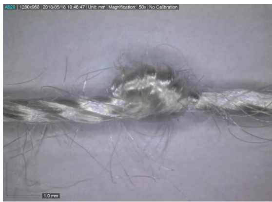
Slika 61. Fotografija konfiguracije U10 nakon procesa habanja
