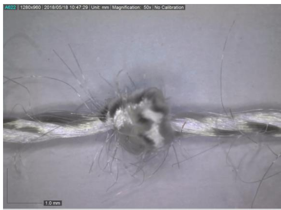
Slika 63. Fotografija konfiguracije U12 nakon procesa habanja
