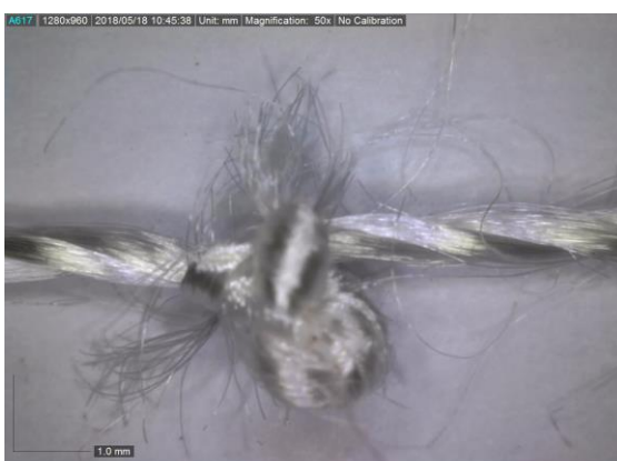
Slika 58. Fotografija konfiguracije U7 nakon procesa habanja
