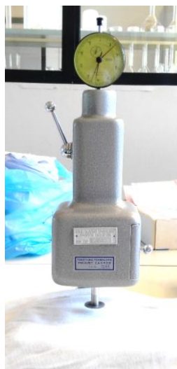
Slika 15. Debljinomjer primijenjen za utvrđivanje debljine uzoraka
