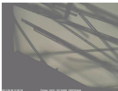
Mikroskopsko određivanje točke taljenja (16x)
