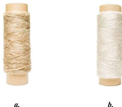
**Slika 11.** Roving pređa: a. NATTEX ROVING©, Dehondtgroup, 100% lan bez uvoja; b. Roving pređa male uvojitosti, Safilin, 100% lan [12]
