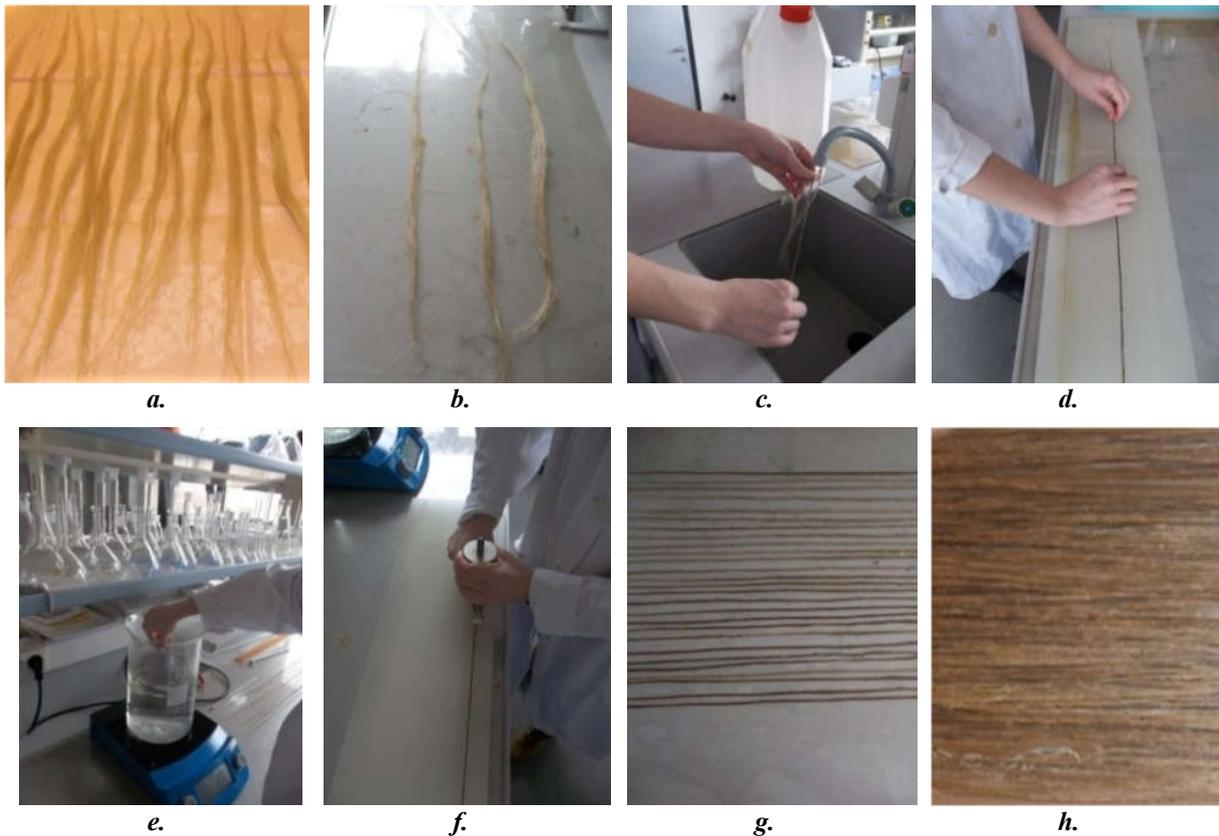
**Slika 18.** Priprava viskooorijentirane pređe iz duljih vlakana predivog lana: a. snopići vlakana, b. snop vlakana raspoređen na dvostruku duljinu, c. močenje snopa vlakana u hladnoj vodi, d. razvlačenje snopa vlakana, e. izlaganje snopića vlakana djelovanju vode temperature 70 °C, f. prolaz pritiskom dijelom uređaja s kotačićem, g. sušenje pređe pri sobnoj temperaturi h. pripremljena roving pređa iz lanenih vlakana
