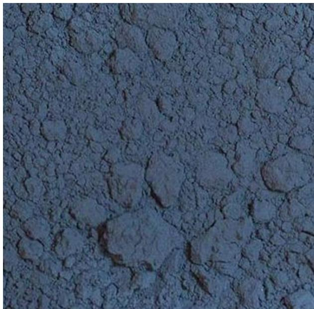
Sl. 7: Željezov(III) fosfat oktahidrat;  $\text{Fe}_3(\text{PO}_4)_2 \cdot 8\text{H}_2\text{O}$ ; „Vivijanit“ [36]
