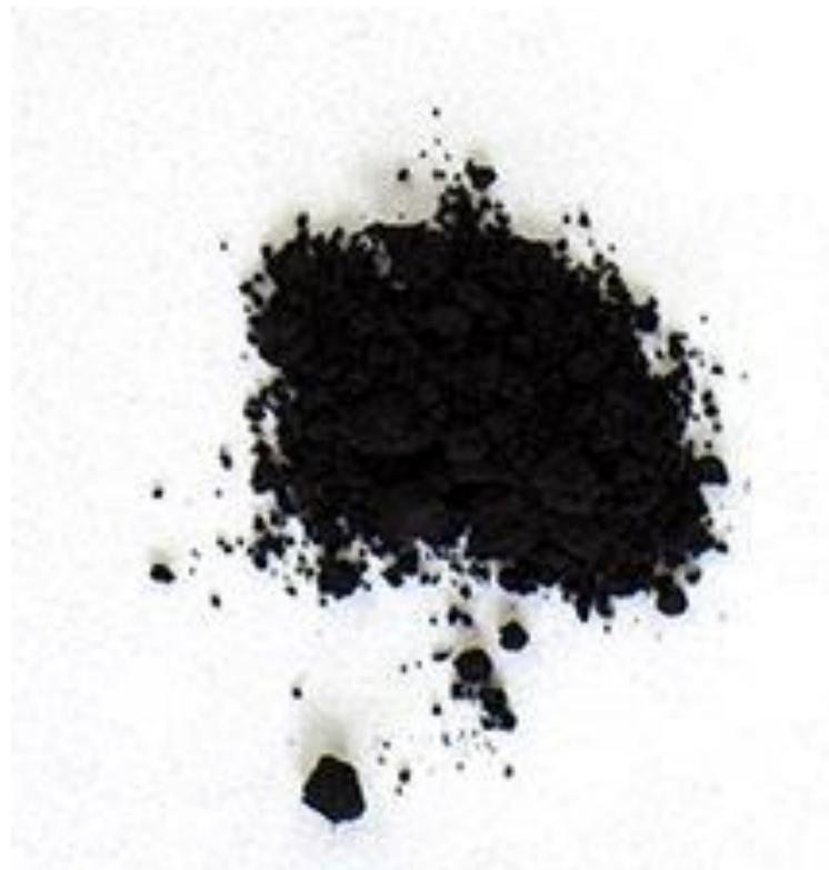
Sl. 15: Željezov pigment iz reda spinela;  $MnFe_2O_4$ ; „Spinel crna“ [98]
