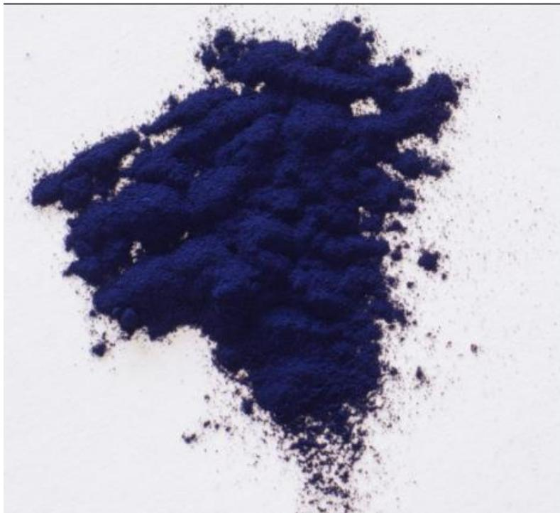
Sl. 2: Željezov(III) heksacijanoferat(II);  $\text{Fe}^{\text{III}}_4[\text{Fe}^{\text{II}}(\text{CN})_6]_3 \cdot n\text{H}_2\text{O}$ ; „Prusko modrilo“ [16]
