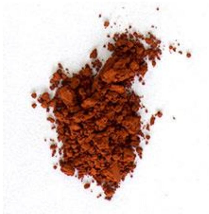
Sl. 16: Željezov(III) oksid;  $\text{Fe}_2\text{O}_3$ ; „Pompeian red“ [121]
