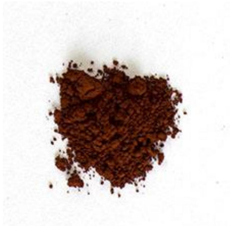
Sl.14: Hidratizirani željezov(III) oksid hidroksid;  $\text{FeO(OH)} \cdot \text{nH}_2\text{O}$ ; „Umbre“ [86]
