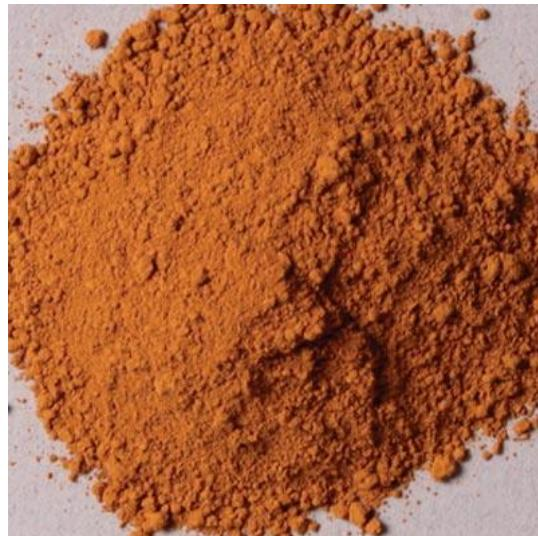
Sl. 9: Hidratizirani željezov(III) oksid hidrooksid;  $\text{FeO(OH)} \cdot n\text{H}_2\text{O}$ ; „Raw Sienna“ [52]
