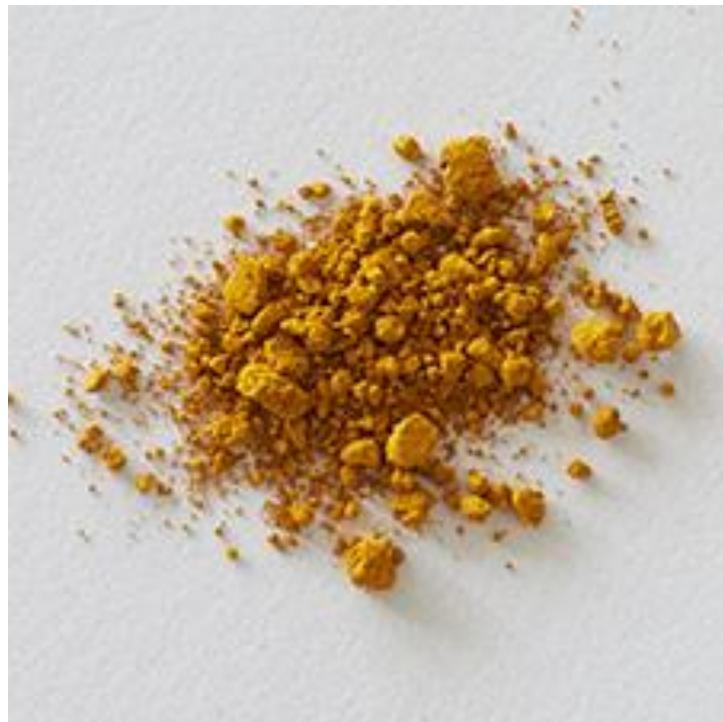
Sl. 12: Hidratizirani željezov(III) oksid hidroksid;  $\text{FeO(OH)} \cdot n\text{H}_2\text{O}$ ; „Oker“ [67]
