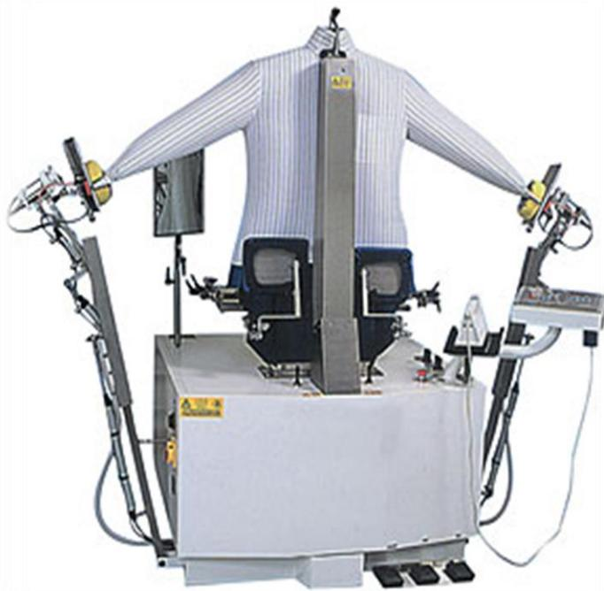
Sl. 3 Stroj za glaćanje propuhivanjem tehnološke pare [3]
