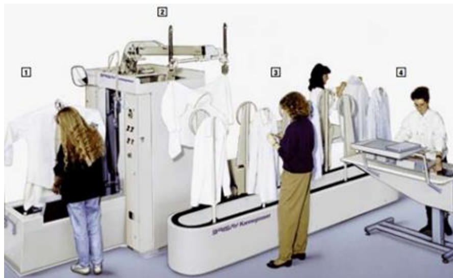
Sl. 27 Prikaz modularnog tipa glačanja u tehnološkom procesu dorade muške košulje [17]
