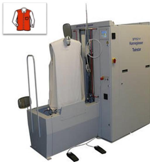
Sl. 26 Stroj za tunelno glaćanje tijela košulje oznake HP-V2 [17]
