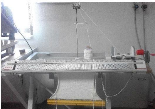
Slika 57. Izrada finalnog proizvoda na ručnom ravnopletačem dvoigleničnom stroju za pletenje Singer
