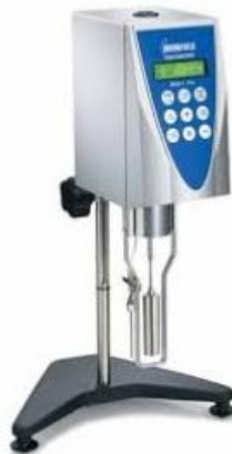
Slika 22. Viskozimetar Brookfield DV II+ [87]
