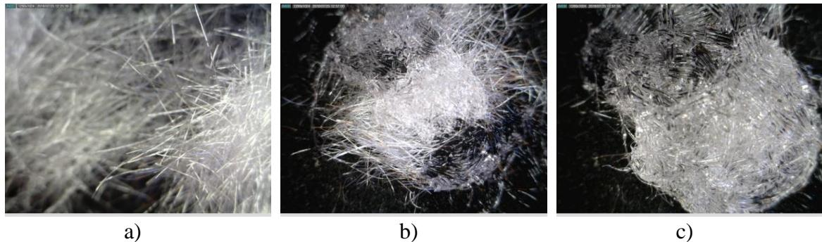
**Slika 2** a) Superupijajuće vlakno b) Pijelaz vlakna u gel c) Vlakno u gel stanju
