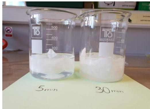
**Slika 8** Jastučići s uzorkom uronjeni u 0.9% tekućinu NaCl
