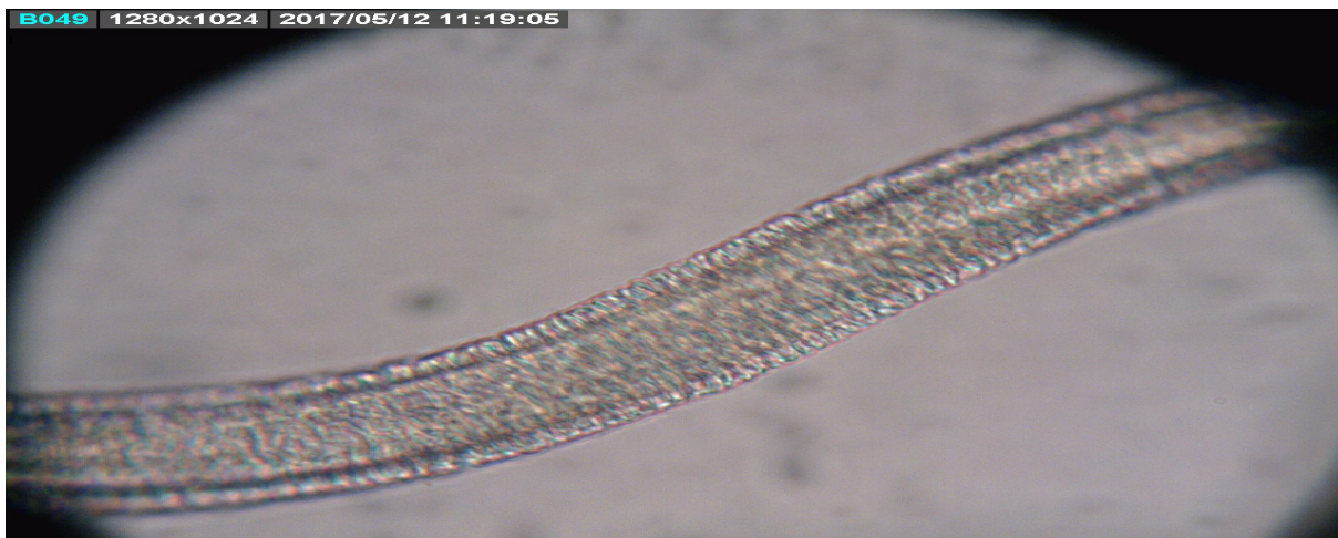
Slika 15. Reakcija poliamida s Frotte I reagensom
