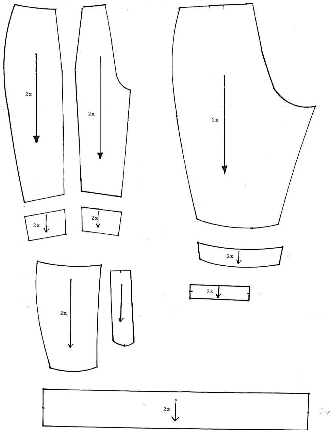
Slika 29. Krojni dijelovi osnovne tkanine za model ženskih hlača
