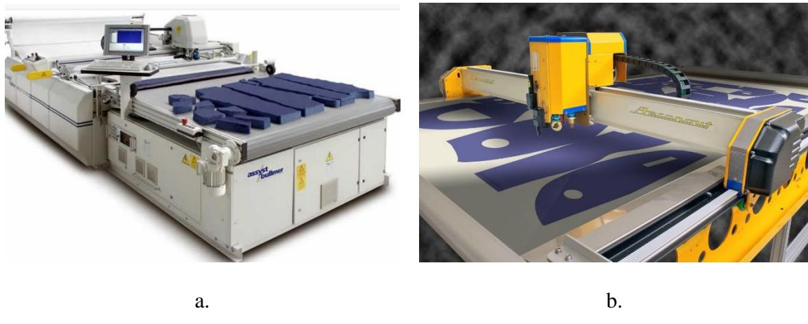
**Slika 1.** Agregati za krojenje: a. s ubodnim oscilirajućim noževima; b. s laserskim zrakama [1]
