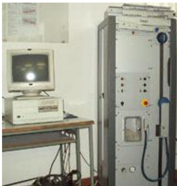
Slika 9. Dinamometar STATIMAT M- t.t. Textechno, Njemačka
