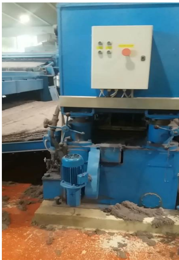
Slika 3. Iglanje položenog runa sa faze polaganja runa na križnom polagaču
