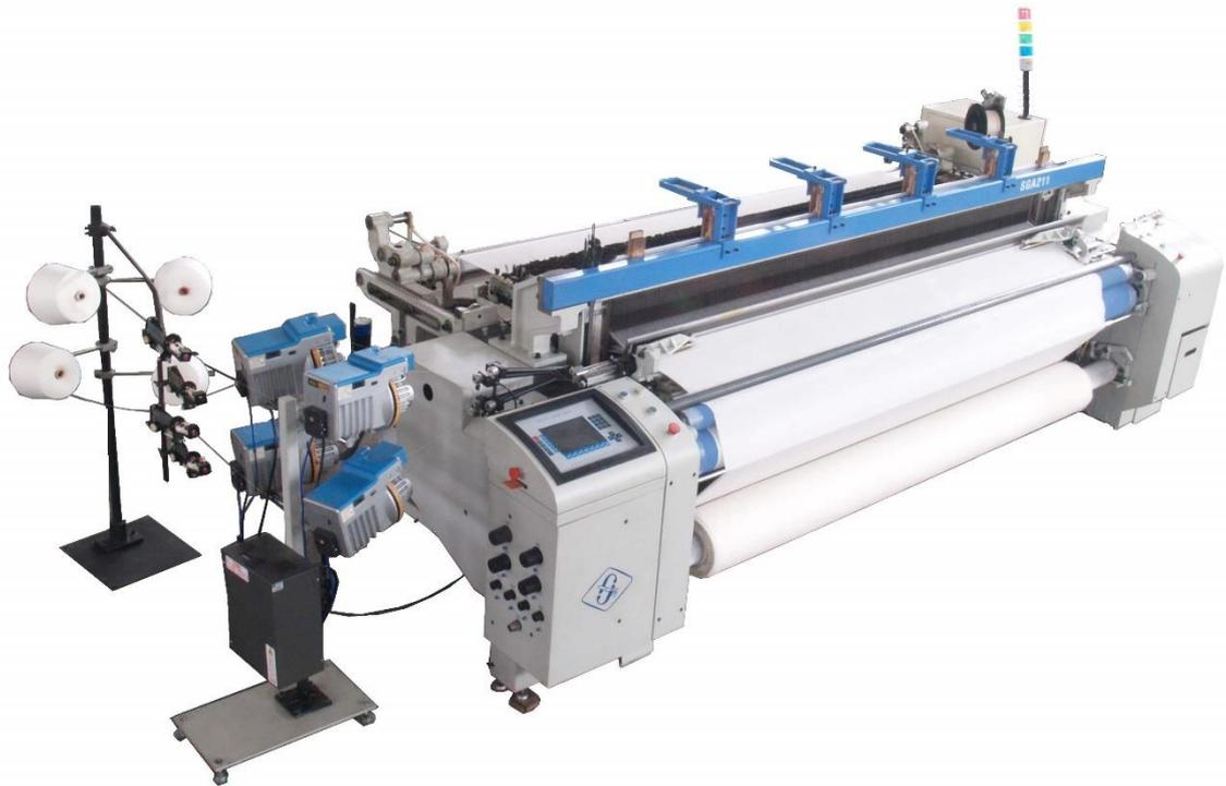
**Sl. 28.** Stroj za tkanje sa zračnim mlazom, IZVOR: [www.texindex.com](http://www.texindex.com)
