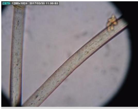
Slika 28. Mikroskopiranje vlakna u ClZnI
