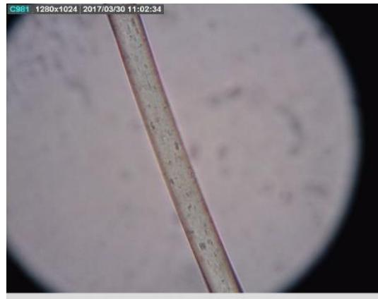
Slika 29. Mikroskopiranje vlakna u zagrijanom ClZnI
