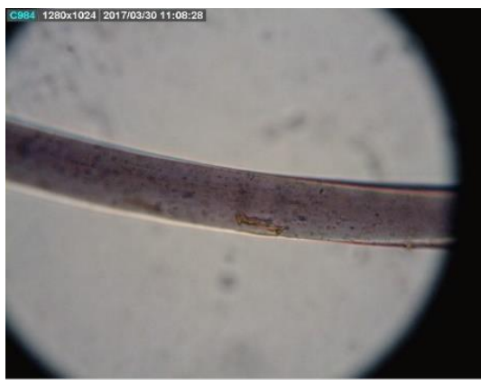
Slika 31. Mikroskopiranje vlakana u ClZnI
