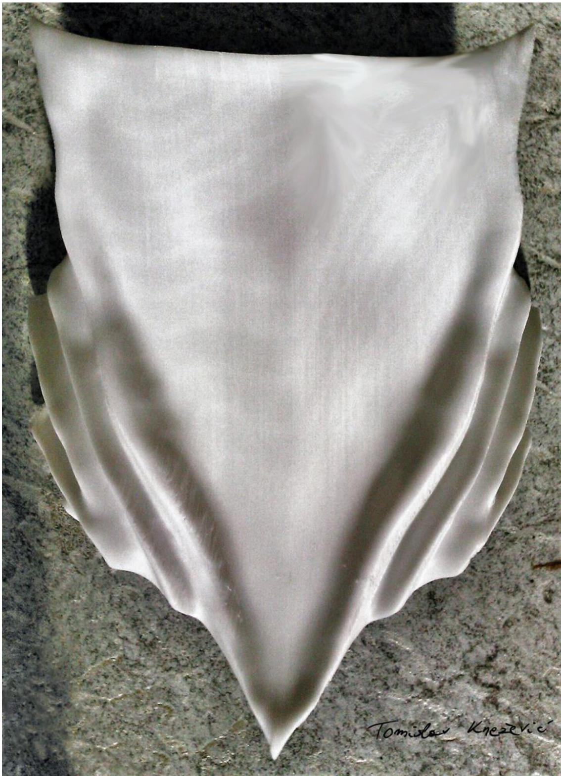
Vlastiti izvor, izrađeni prototip, 2017., 3D tisk pomoću ABS materijala, 34.5 cm x 29.5 cm x 2 mm.
