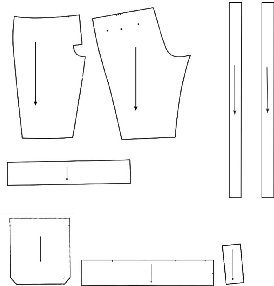
Sl. 26. Krozni dijelovi osnovne tkanine za model muških hlača za mačevanje
