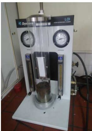
Slika 10. Uređaj za mjerenje graničnog indeksa kisika [29]
