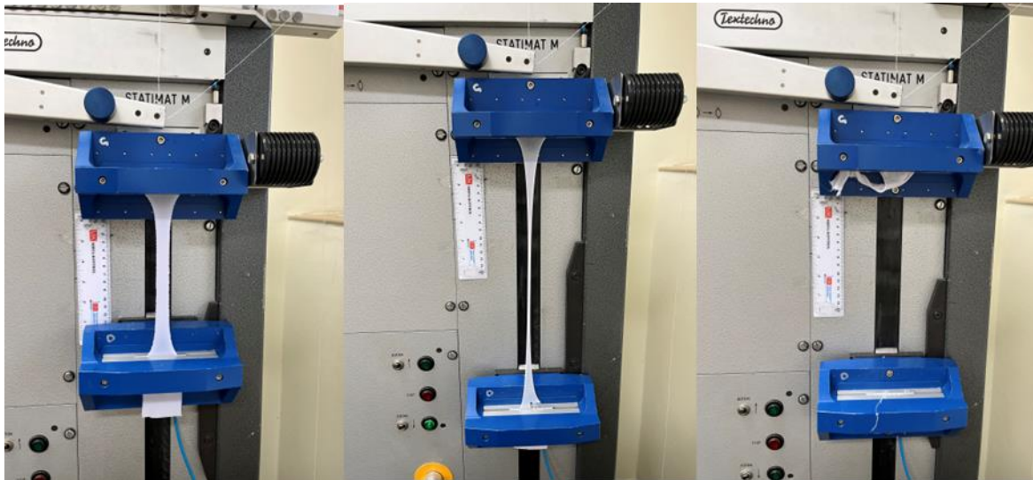
Slika 3.2.3.2 Tijek ispitivanja vlačnih svojstava pletiva
