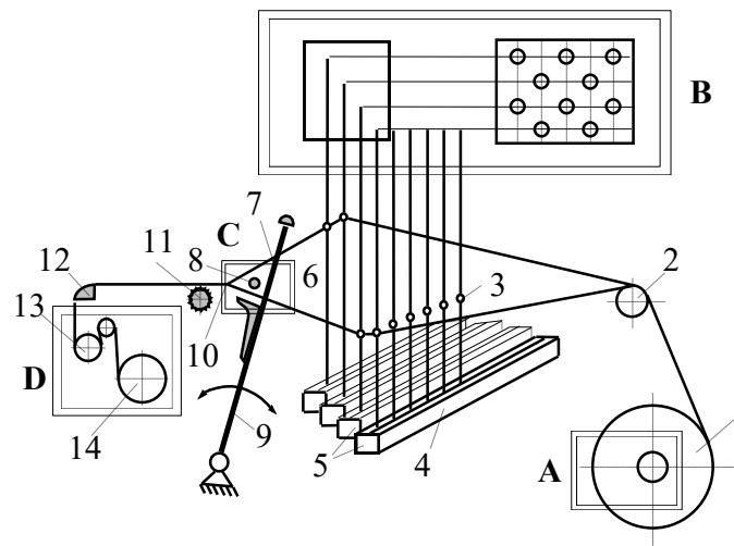
*Slika 10. Dijelovi tkalačkog stroja; 1 – osnovin valjak, 2 – prijevojnik, 3 – kotlaci, 4 – listovi, 5 – ničanice, 6 – zjeb, 7 – brdo, 8 – potka, 9 – bilo, 10 – pritkajna linija, 11 – raširivač, 12 – prsnica, 13 – povlačni valjak, 14 – robni valjak*
