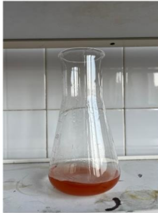
Slika 12. Argentometrijska titracija: pretitrirana otopina NaCl
