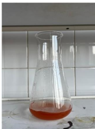
Slika 12. Argentometrijska titracija: pretitrirana otopina NaCl
