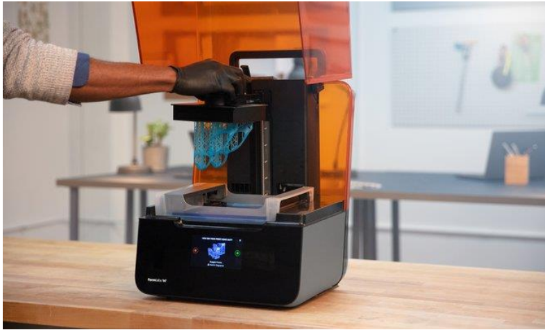
Sl.7. SLA 3D tiskalo, proizvođač Formlabs [25]
