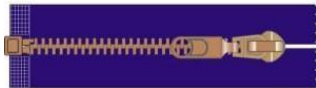
Sl. 14. Zupci metalnog zatvarača
