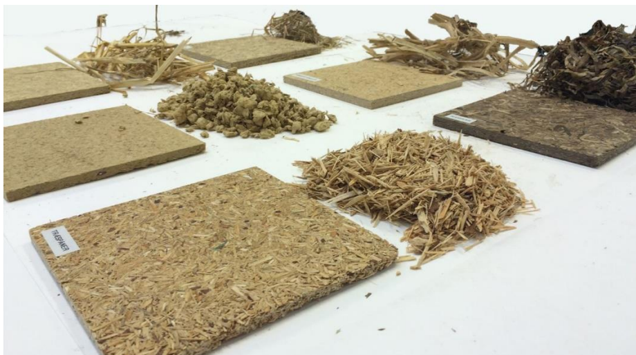
Slika 11. Bio-kompoziti u građevinarstvu [14]
