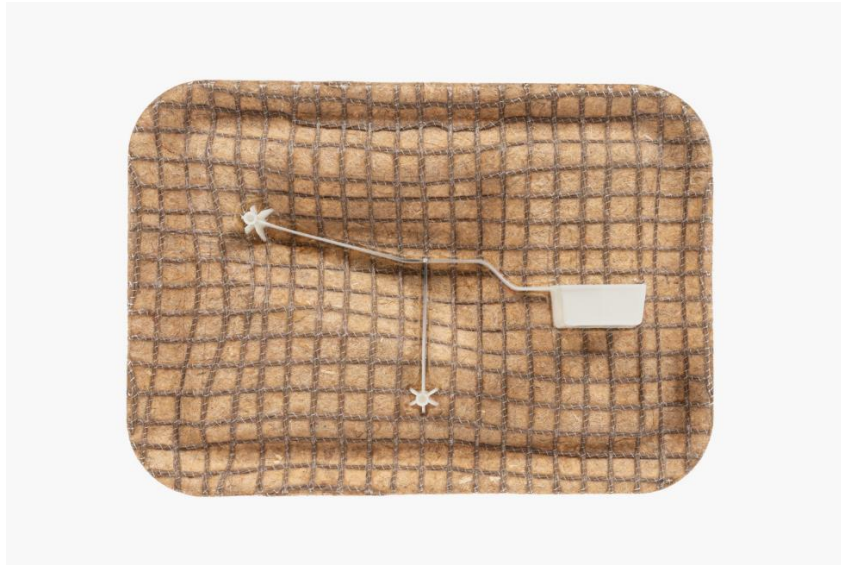
Slika 10. Bio-kompoziti za unutrašnjost automobila [14]
